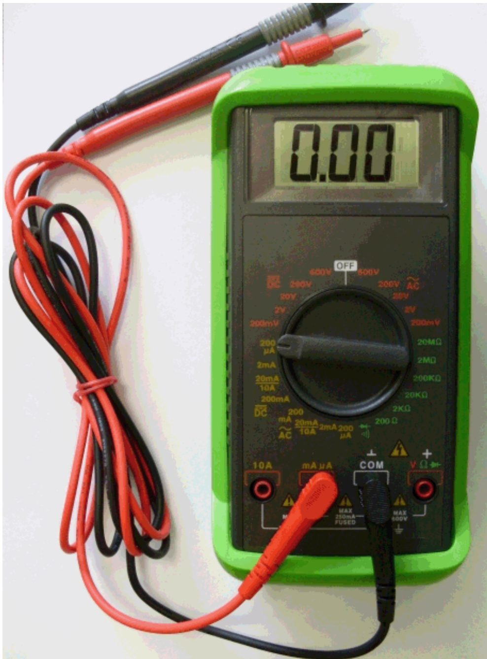
figure 3. Για εντάσεις ρεύματος μεταξύ 200\text{mA} και 10\text{A} , συνδέσατε το κόκκινο καλώδιο στην είσοδο "10A"
